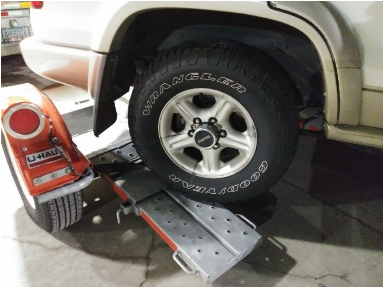
Hình 5. Dây ràng tuột khỏi bánh xe và bánh xe trượt khỏi vị trí của nó trên tow dolly, khiến cho đầu xe bị xoay ra ngoài
