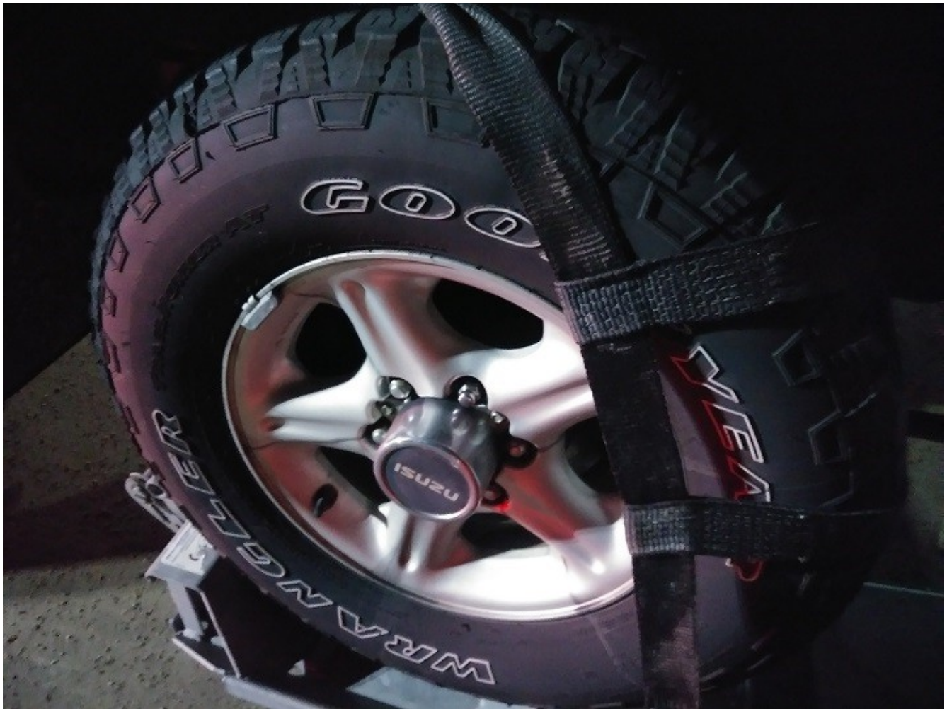
Hình 4. Bánh xe được ràng xuống tow dolly
