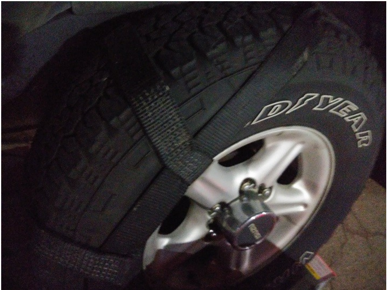
Hình 3. Bánh xe được ràng xuống tow dolly
