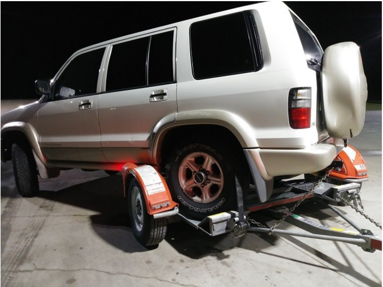
Hình 6. Đầu xe xoay ra ngoài, xe không còn thẳng hàng với tow dolly và xe kéo khiến cho xe kéo bị chao đảo
