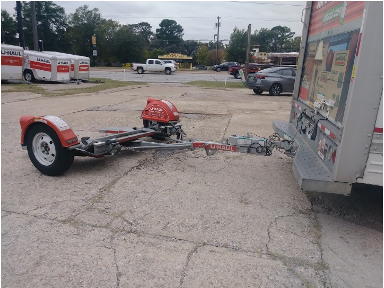
Hình 2. Tow dolly được gắn vào xe U-Haul
