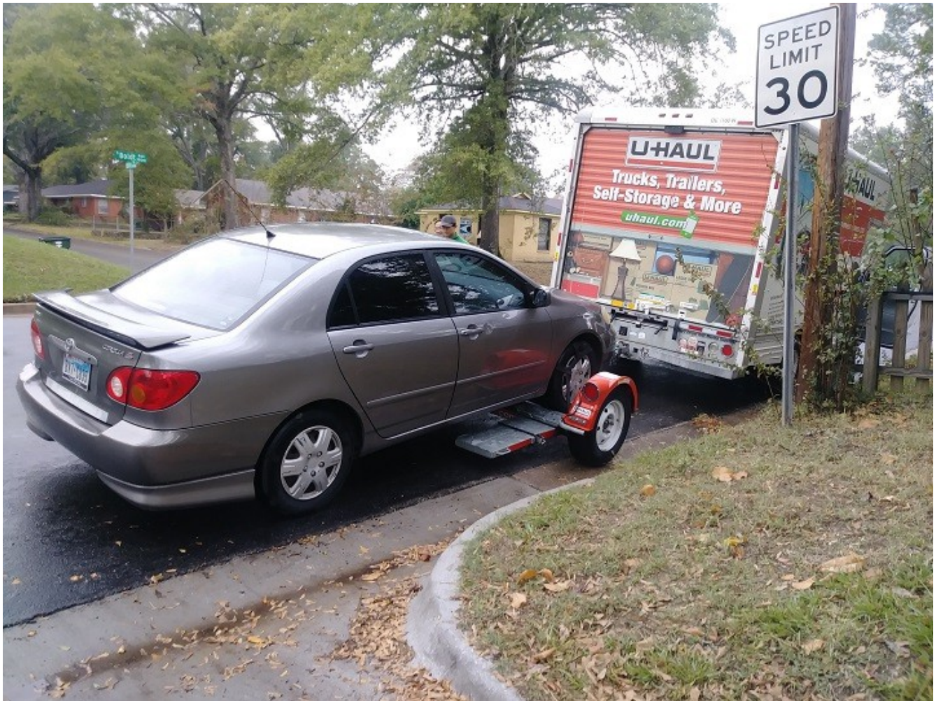
Hình 8. Chiếc Toyota được kéo trên tow dolly không đúng quy cách vì loại xe Toyota này có hộp số tự động, lái bằng hai bánh sau
